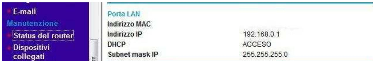
Nel caso riportato occorre settare la EZL in modo tale che si agganci al router tramite un indirizzo IP fisso compreso nella numerazione 192.168.0.2 e 192.168.0.255.
