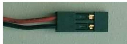
togliere il cavo e relativo fastom esistente, quindi sgucciati i fili + e - del doppino telefonico (o similari) se ne piega l'estremità a formare un occhiello del diametro di circa 3 mm. Una modesta stagnatura dell'occhiello, a patto di disporre del relativo saldatore a stagno, non guasta. Quindi si inseriscono i due cavi (con i relativi occhielli) negli alloggiamenti (vuoti) del connettore e li si blocca con un paio di giri di nastro isolante.
