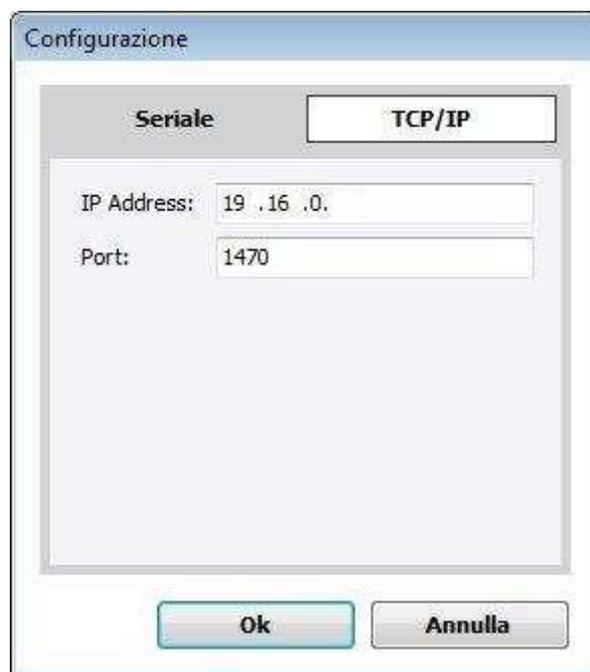
La scheda EZL può comunicare efficacemente senza nessun problema (almeno da me verificato) tramite il più comodo protocollo TCP/IP. È possibile, scaricando gli appositi driver settare anche una comunicazione seriale, ma si perde così lo spirito principale di connessione tramite la scheda EZL, cioè rendere disponibili i dati nella rete sia domestica che esterna in connessione diretta, senza aggiunta di driver o dispositivi intermedi.
