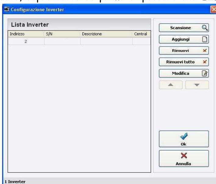
III) Ultima precisazione: la scheda EZL accetta una sola connessione per volta (salvo cambiamento di questa opzione con Ezlconfig). Pertanto non è possibile monitorare l'inverter con 2 PC diversi contemporaneamente. Il tentativo di accesso del secondo PC restituirà un errore di connessione che potrebbe indurre erroneamente a pensare di aver commesso errori di settaggio.
