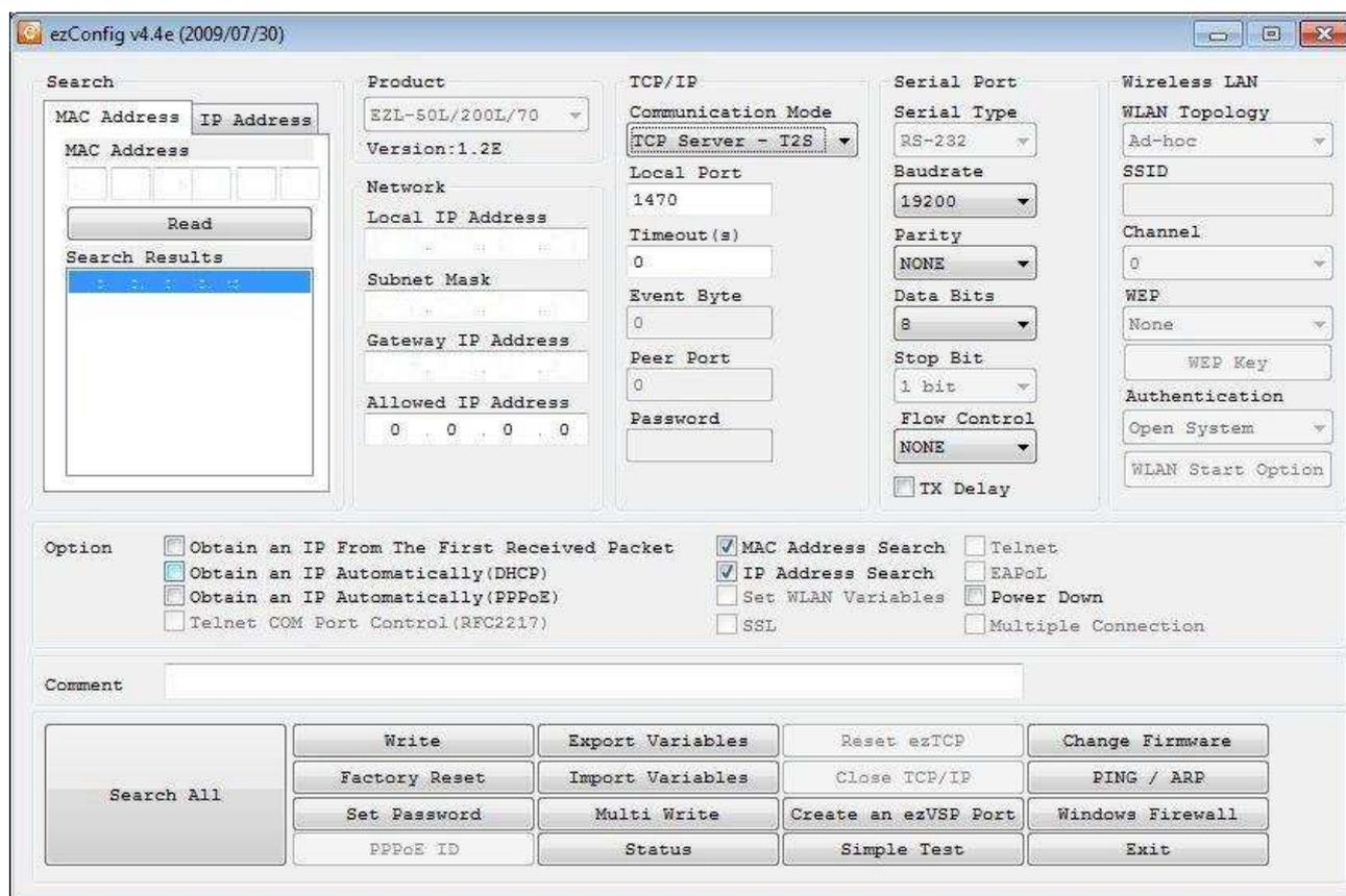
A questo punto basta inserire nella mascherina TCP/IP di Aurora Comunicator l'indirizzo IP scelto per la EZL, cercare l'inverter e successivamente avviare la connessione (funziona solo a inverter acceso naturalmente). Potrebbe essere necessario riavviare il router prima di vedere la EZL, in ogni caso potete controllare
